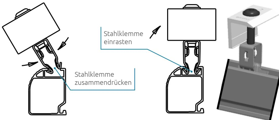
Endklemme in BP3 durch Zusammendrücken gegebenenfalls in gewünschte Position verschieben, dann Solarmodul befestigen, Anzugsmoment: 12 Nm
