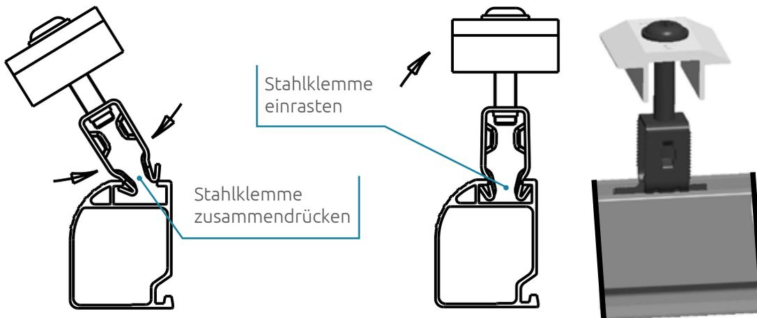
Mittelklemme in BP3 durch Zusammendrücken gegebenenfalls in gewünschte Position verschieben, dann Solarmodul befestigen, Anzugsmoment: 12 Nm
